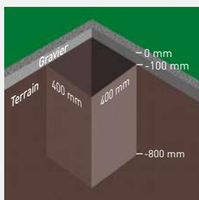
Creuser tous les trous des fondations où viendront se loger les poteaux (400 x 400 x 800 mm).
